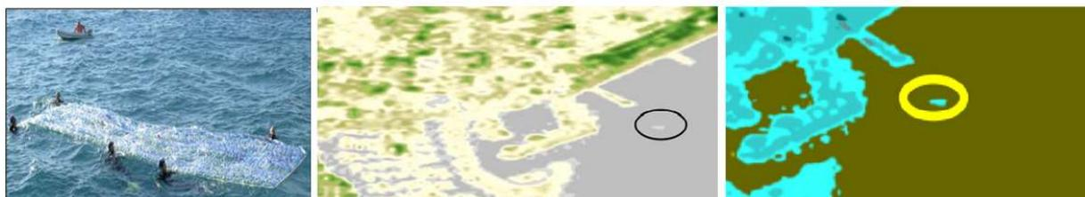
Figure 5. Expérience menée sur la plage de Limassol sur l'île de Chypre. A gauche, panneau de 3 x 10 m de bouteilles plastiques ; au Centre, image fournie par une caméra infrarouge ; à Droite, images fournies par le satellite Sentinel 2 (Koumi et al., date non précisée)
