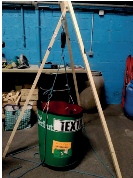
peson suspendu sur trépied
